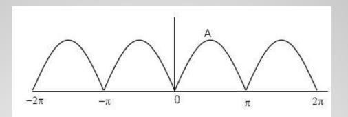
$$\begin{split} V_{in}(t) &= A \sin(\omega t) \\ V_{out}(t) &= |A \sin(\omega t)| \end{split}$$
